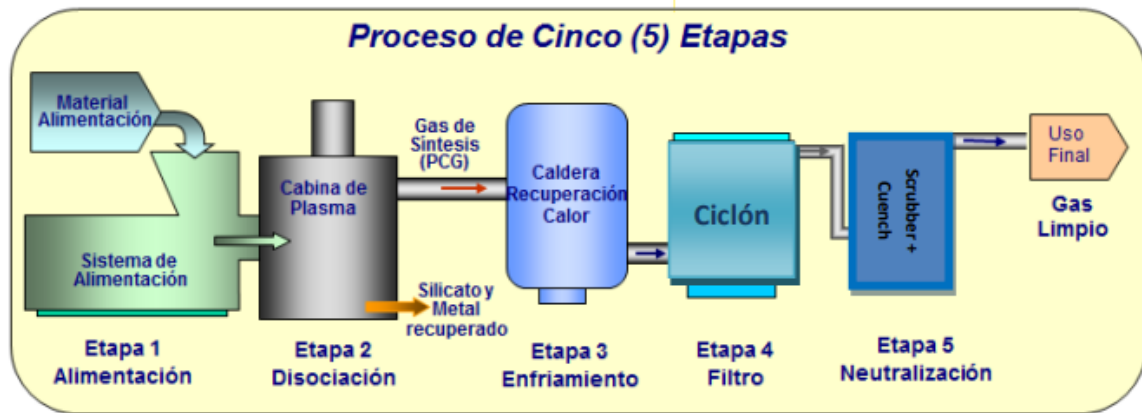
Figura 3: Etapas del proceso de gasificación por plasma (Fuente: Valenciano, 2015)
