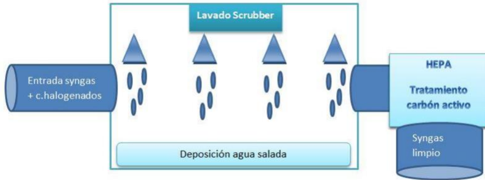
Figura 7: Proceso de la torre de lavado de Scrubber (Fuente: Valenciano, 2015)
