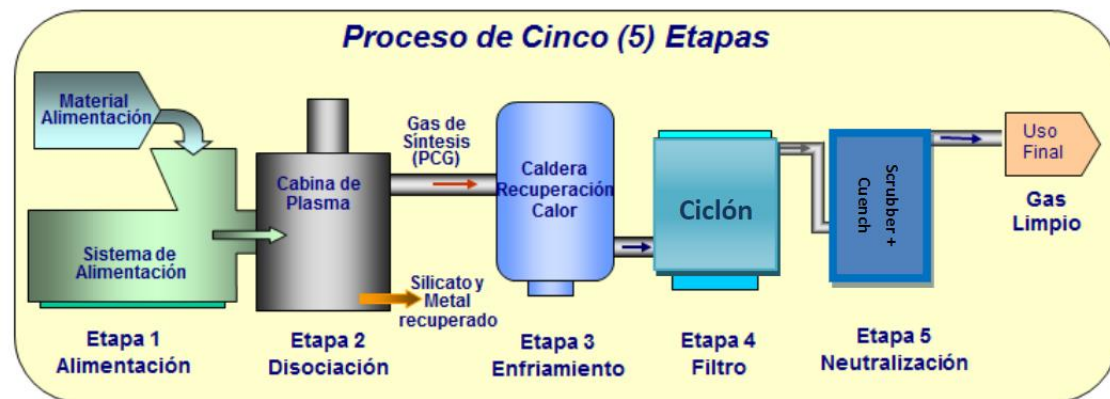
Figura 7 Etapas del proceso de gasificación por plasma (Almudena Valenciano, 2015)
