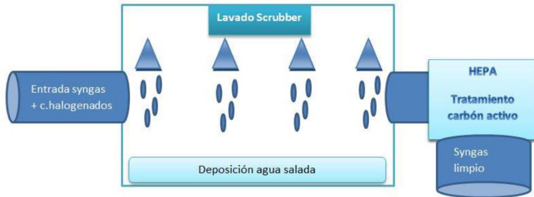
Figura 9: Esquema del sistema de neutralización (Valenciano López, 2015)
