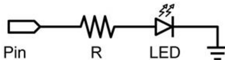
Fig 31. Esquema conexión LED
