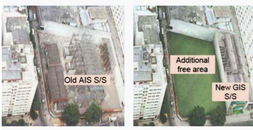
Figura 24 Comparación real de una subestación AIS con una subestación GIS (Fuente: crushtymks)
