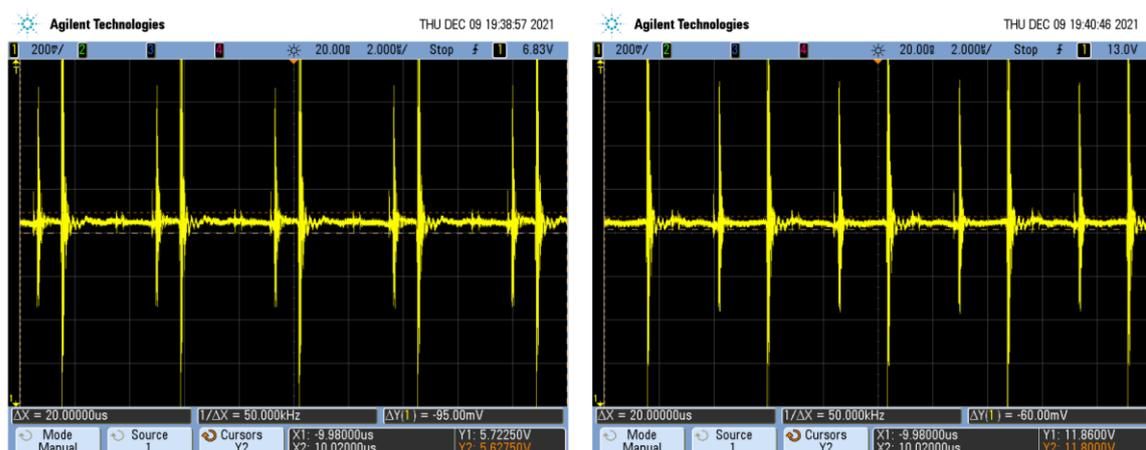
Figura 22. Tensión de Entrada del Elevador ( $I_{zq}$ :  $V_{in} = 6,83V$ ,  $D_{cha}$ :  $V_{in} = 13,0 V$ )
