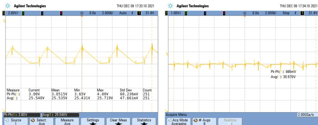
Figura 2. Tensión de salida del Elevador (Izq:  $V_{in} = 6V$ , Dcha:  $V_{in} = 12V$ )
