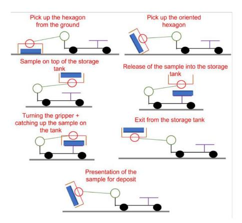
Figure 10: Muestra del funcionamiento del robot
