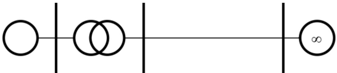
Figura 4-2: Diagrama unifilar de un generador síncrono conectado a un nudo de potencia infinita.
