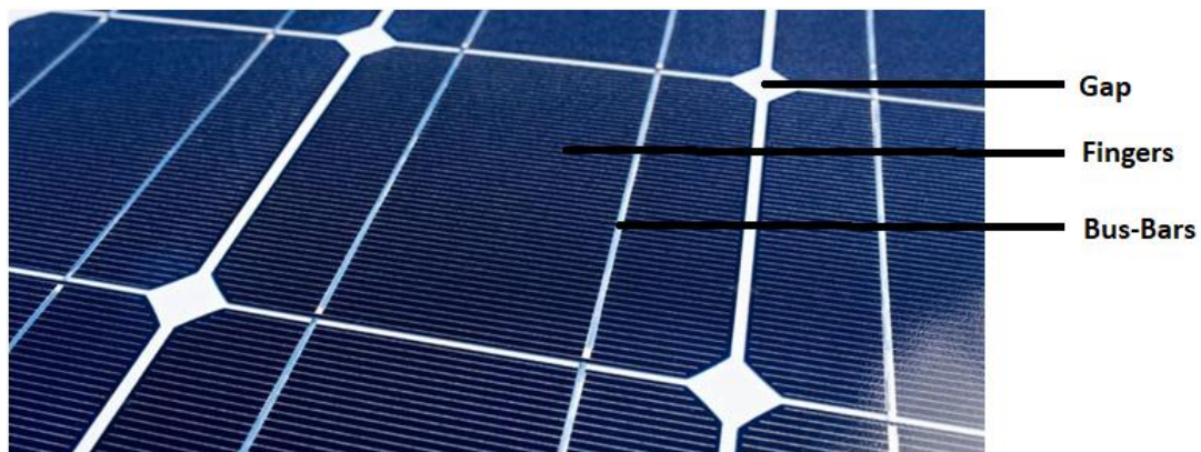
Figura 14 Busbars y fingers en un panel solar [ASIC22]
