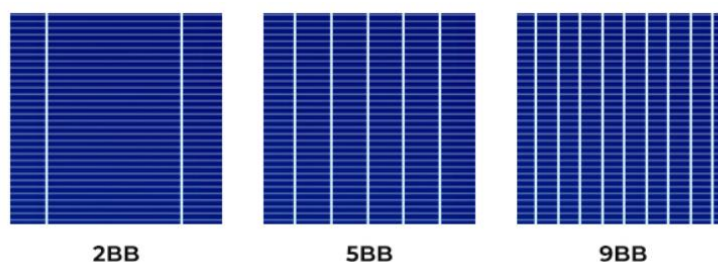
Figura 20 Esquema de paneles de 2BB, 5BB y 9BB [NOSO20]
