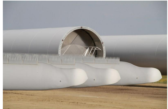
Figura 12: Borde serrado en las aspas del aerogenerador (siemensgamesa.com)
