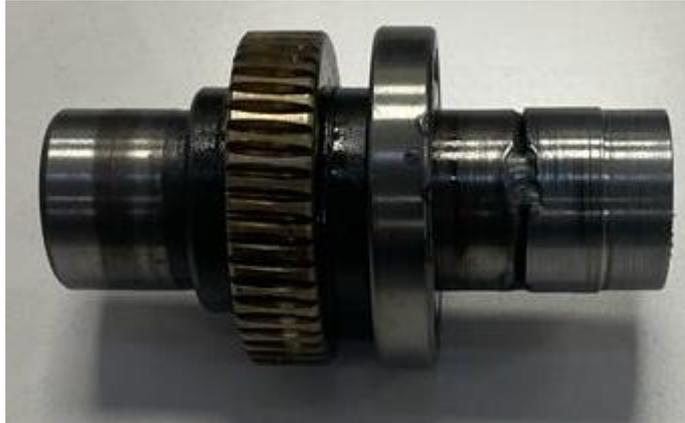
*Figura 34: Eje transmisor modificado.*
