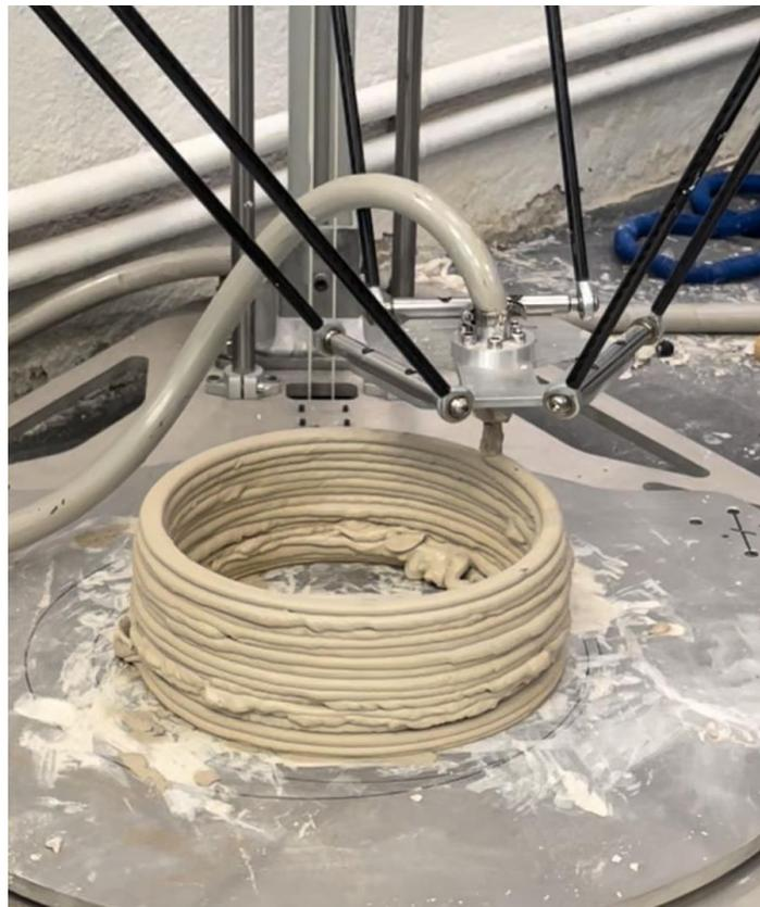
*Figura 40: Impresión con overflow.*
