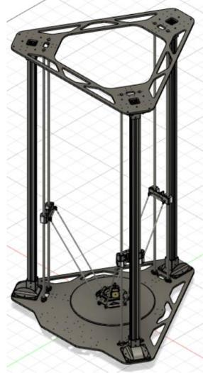
*Figura 12: Diseño de la estructura en Fusion 360.*
