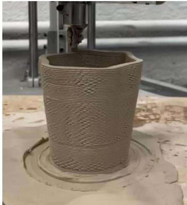
*Figura 38: Impresión con paredes finas y flujo ligeramente bajo.*
