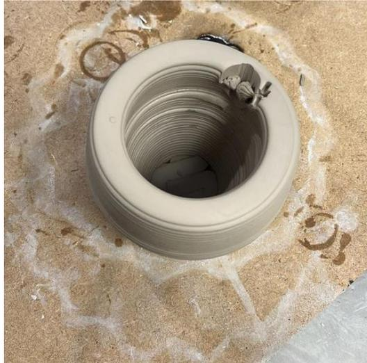
*Figura 37: Impresión con paredes gruesas y con un fallo por burbuja de aire.*
