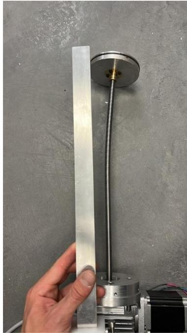
*Figura 32: Curvatura tornillo sinfín.*
