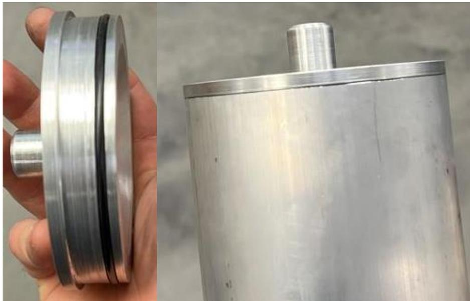
*Figura 23: Tapa superior del extrusor y ajuste.*
