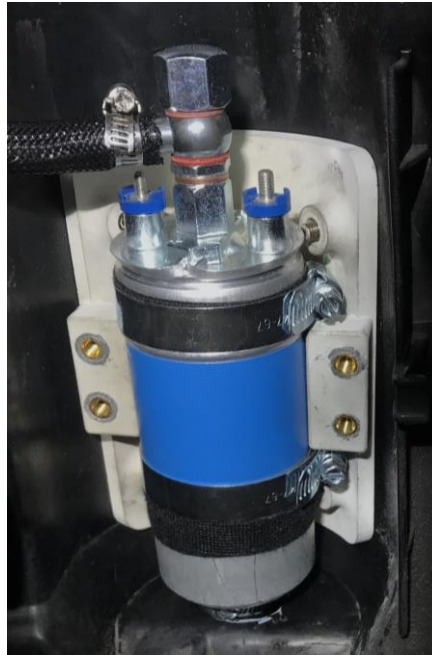
Figura 44: Bomba de combustible
