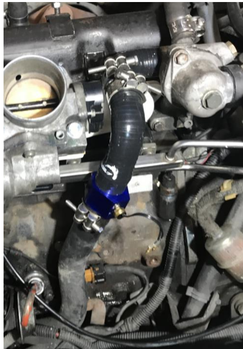
Figura 47: Cambios al circuito refrigerante
