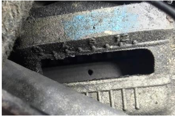
Figura 27: Marcas de sincronización del encendido
