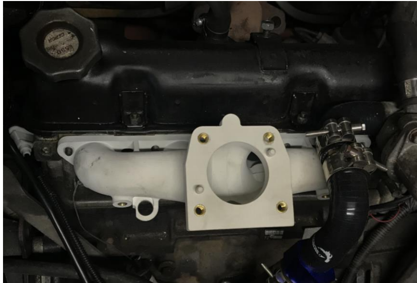
Figura 36: Colector de admisión instalado en la culata
