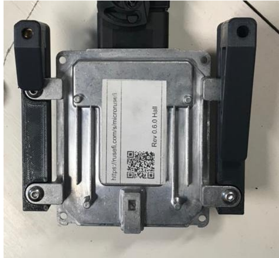
Figura 4: Centralita montada en el soporte
