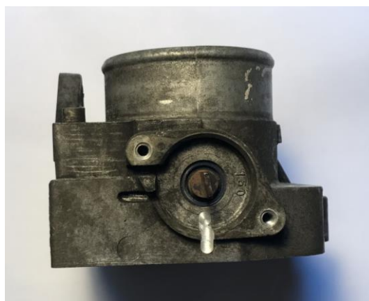
Figura 39: Mariposa después de las modificaciones
