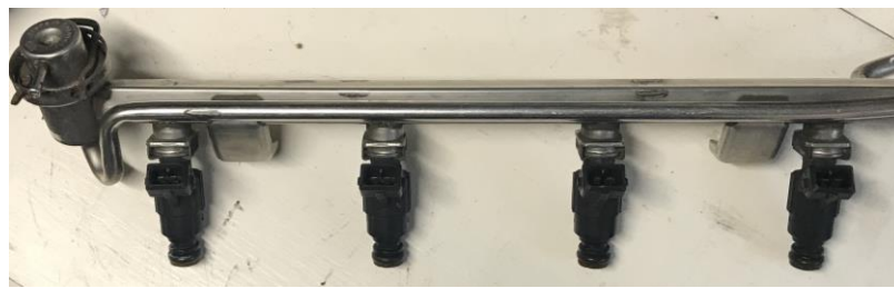
Ilustración 2: Rail de combustible con inyectores y regulador de presión
