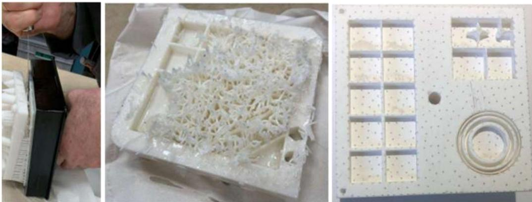
*Figura 54: Fase de retirada del material de soporte y la huella de este proceso en la pieza.*
