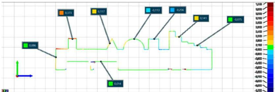
Figura 72: Sección cruzada de ángulos y geometrías salientes MJF.
