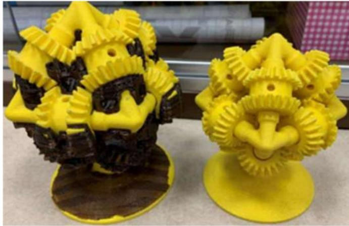
*Figura 7: Ejemplo del laboratorio de ICAI del antes y el después de la extracción del material de soporte con el uso de la cuba de ultrasonidos.*
