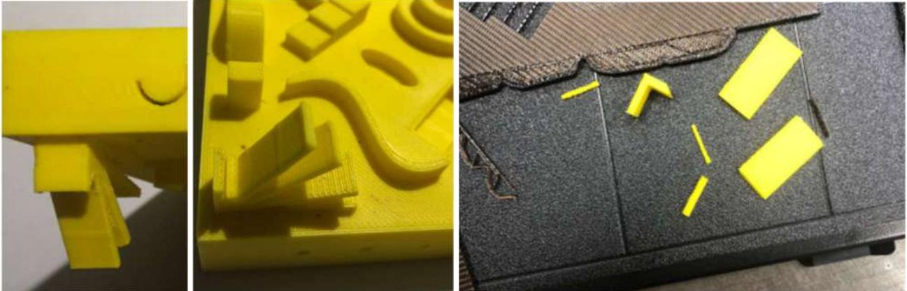
*Figura 45: Ejemplos de defectos provocados por la retirada del material de soporte.*
