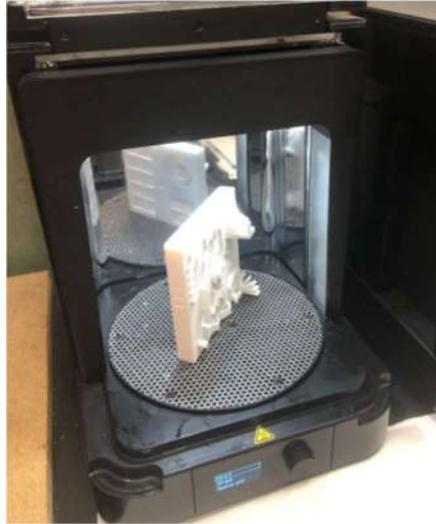
*Figura 55: Prototipo dentro de la máquina de curado.*
