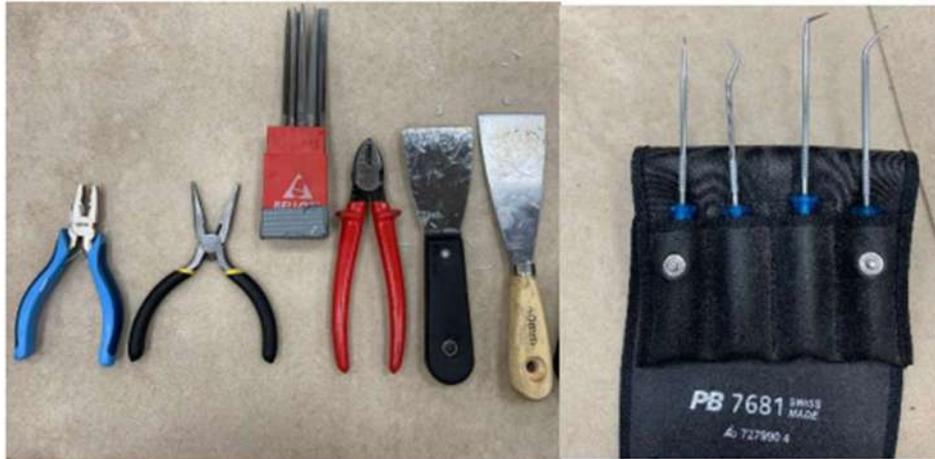
*Figura 40: Utensilios de extracción del material de soporte.*
