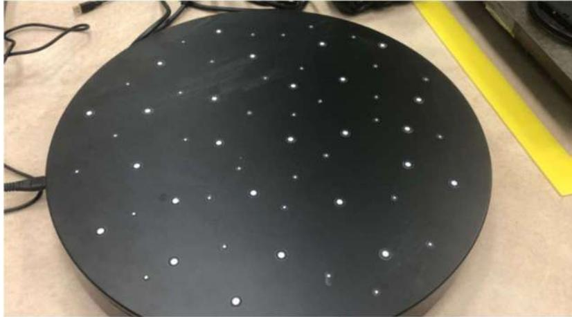
*Figura 61: Placa base rotatoria con los puntos de referencia de escaneado.*
