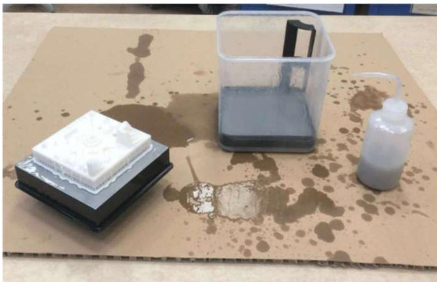
*Figura 52: Primera fase de la limpieza del prototipo chorreando con bote de alcohol.*
