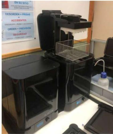
*Figura 53: Prototipo situado en la máquina de inmersión en alcohol.*
