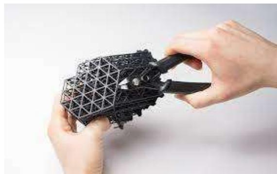
*Figura 8: Ejemplo de retirada de material de soporte en una tecnología FDM.<sup>[15]</sup>*
