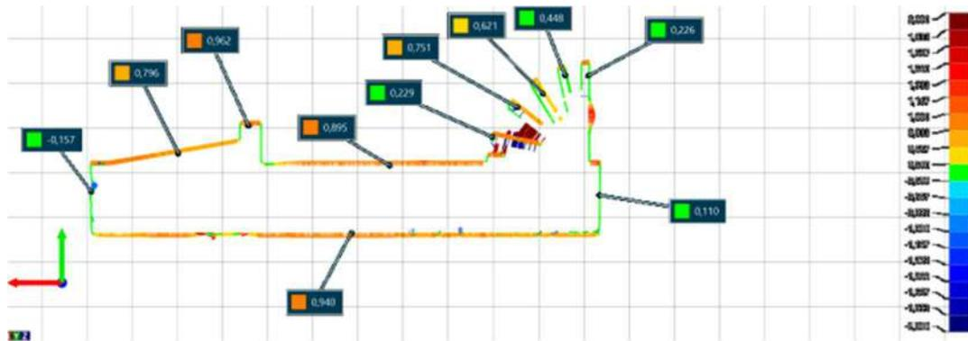
*Figura 79: Sección cruzada de ángulos y voladizos SLA.*
