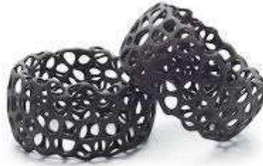
*Figura 13: Ejemplo de pieza obtenida por un proceso MJF.<sup>[18]</sup>*
