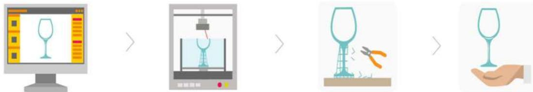
*Figura 11: Fases generales del proceso de SLA.<sup>[5]</sup>*
