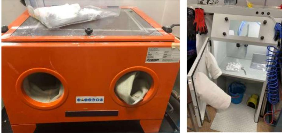
*Figura 58: Máquina de abrasión con aire a 8 kilos (izq.) y máquina de chorreado de detalle (der.).*
