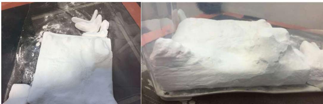
*Figura 57: Modelo obtenido por MJF recién salido de la máquina HP 580C.*
