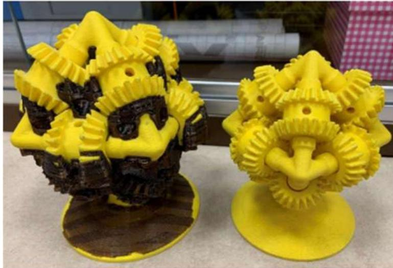
*Figura 43: Ejemplo del laboratorio de ICAI del antes y el después de la extracción del material de soporte con el uso de la cuba de ultrasonidos.*
