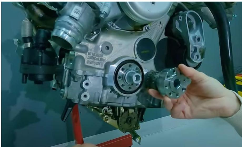
*Ilustración 19 - Foto de Crank-Hub y motor [AXEL23]*
