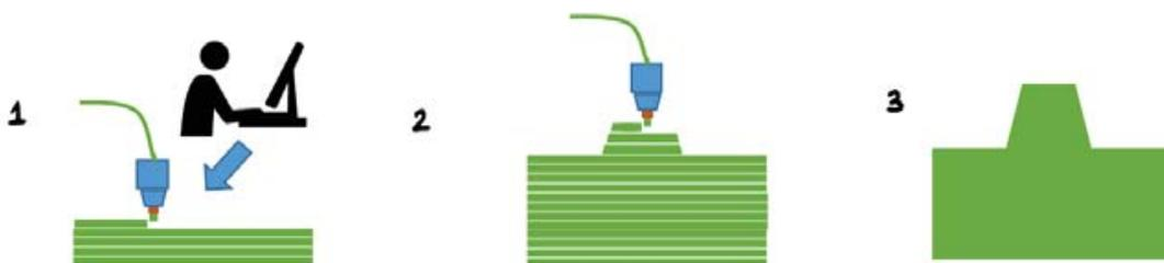
*Diagrama 1.3: Proceso típico simplificado de fabricación aditiva.*
