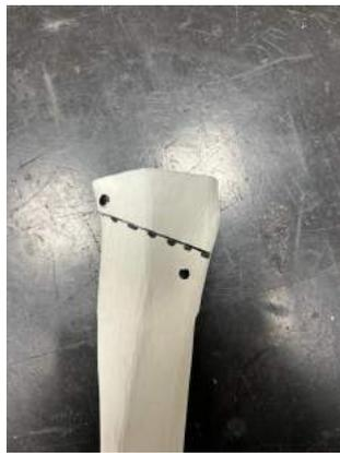
Figura 5.3: Tibia 3D fracturada y taladrada.
