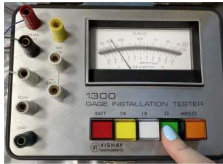
Figura 5.11: Comprobación de las bandas extensométricas.
