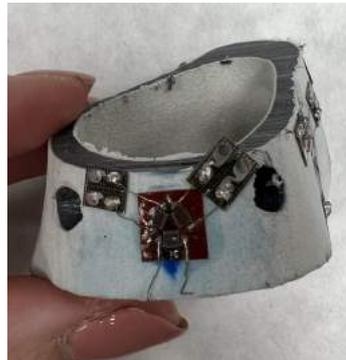
Figura 5.5: Bandas extensométricas de la primera tibia.
