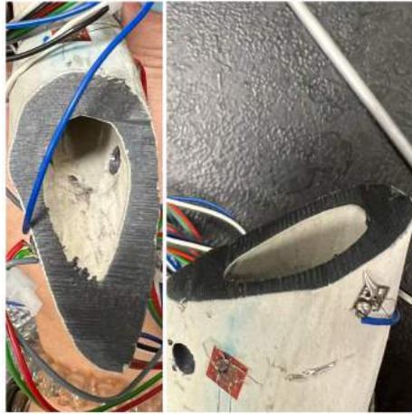
Figura 5.32: Resultado de las caras de la fractura tras tres ensayos.
