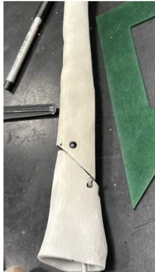
Figura 5.6: Tibia 3D fracturada y taladrada.
