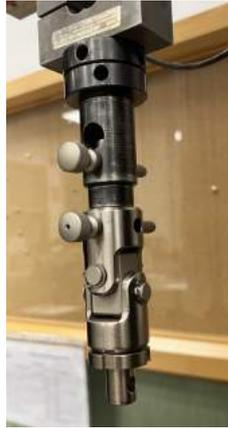
Figura 5.19: Junta cardán empleada en el ensayo.
