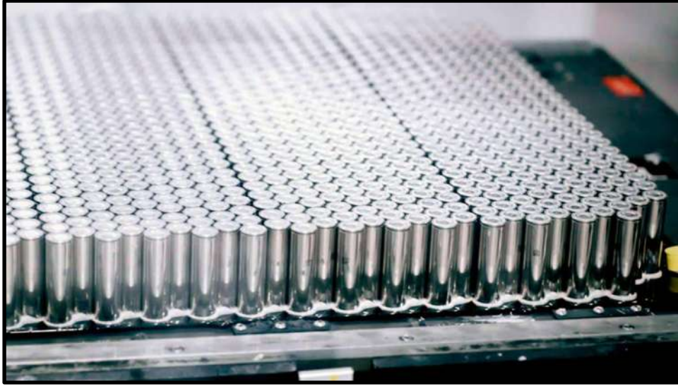
Figura 21. Módulo de baterías de litio. (20)
