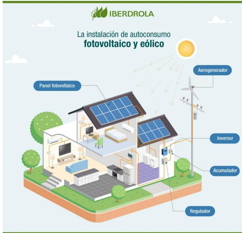
*Figura 4.1. Instalación fotovoltaica y eólica [9]*
