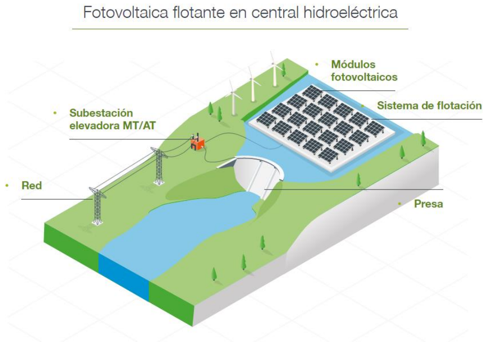
Ilustración 9 Esquema de funcionamiento de una central fotovoltaica flotante conectada a red en un embalse. Iberdrola. [28]
