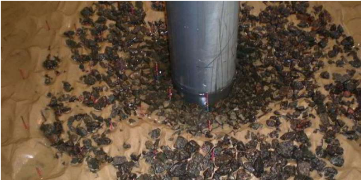
Figura 3. Prueba de protección contra el socavamiento de un modelo de Monopilote [6]
