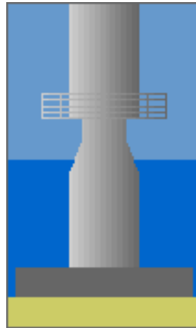
Figura 20. Estructura de soporte rígida por Gravedad [16]
