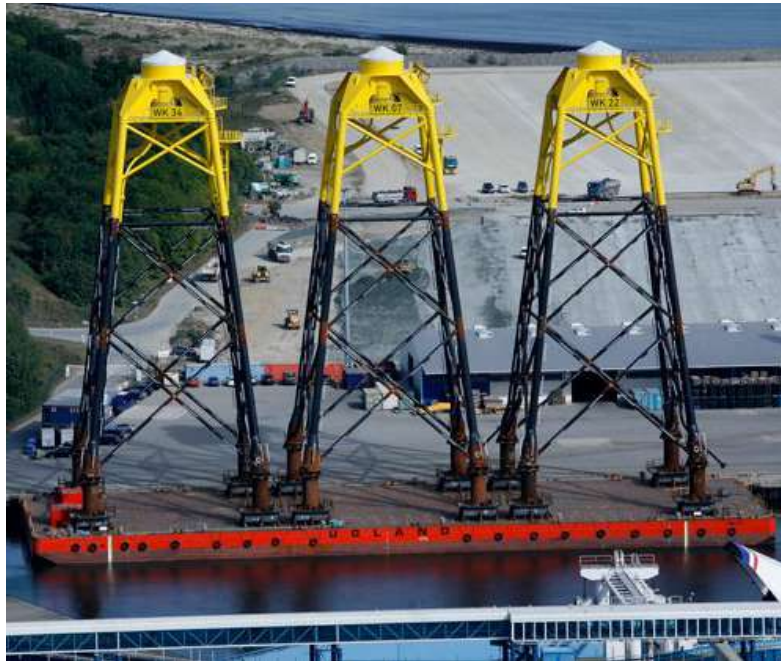
Figura 21. Múltiples estructuras de soporte rígida Jackets en transporte [15]
