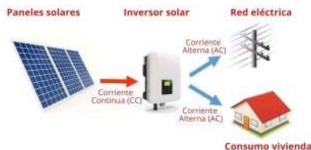
*Ilustración 7: Elementos instalación fotovoltaica*
