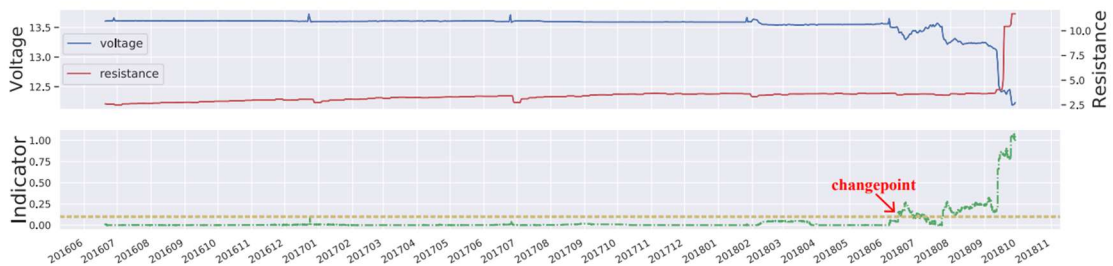
Figura 25: Funcionamiento de la predicción del punto de cambio
