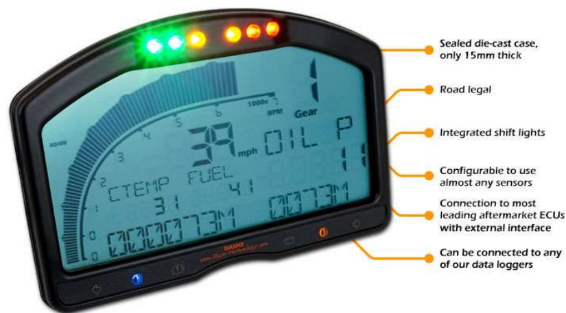
Figura 13: Visualización del display de Dash2
