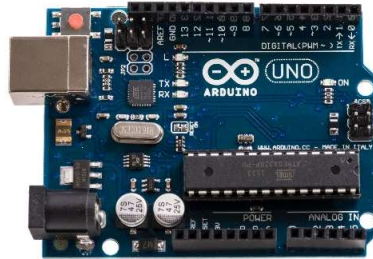
Figura 6: Arduino Uno: placa utilizada para recrear los valores
