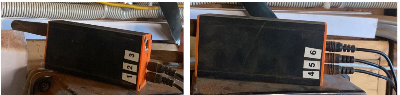
Figura 28: Sensor 1 y 2 que miden corriente alterna. Fuente: Elaboración propia
