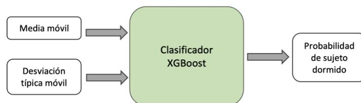
Figura 20: Diagrama de entradas y salida del modelo XGBoost
