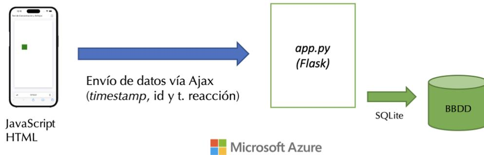
Figura 42: Diagrama de la aplicación web para el juego de velocidad de reacción
