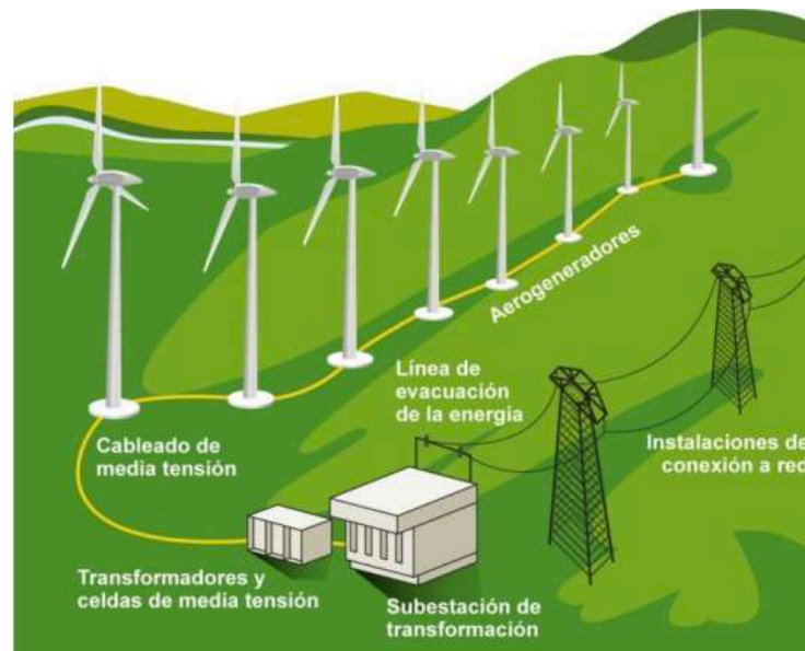
Ilustración 3: Esquema diseño parque eólico. Fuente: Proyecto Final de Carrera
