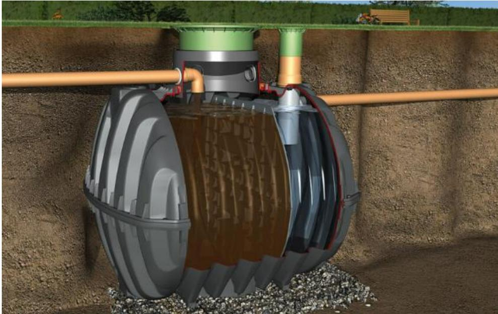
*Ilustración 35. Disposición de la instalación de la fosa séptica. Fuente: Revista Ven América*
