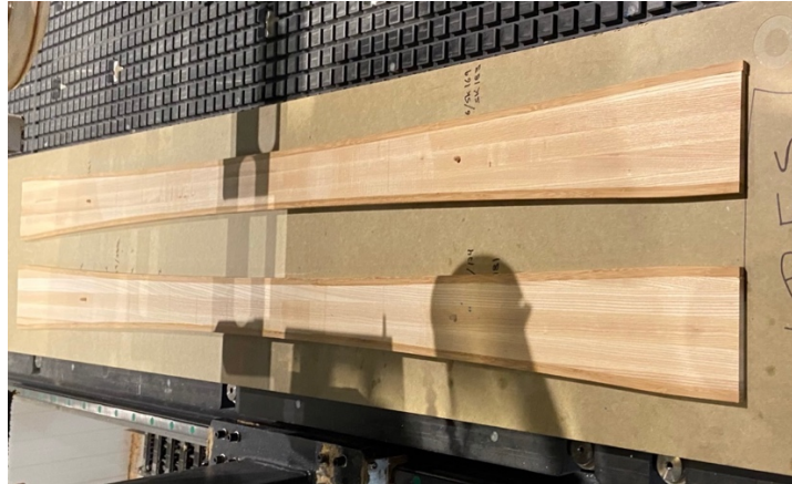
Figura 26: Conjunto núcleo-sidewall listo para ser mecanizado.
