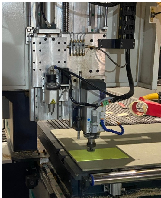
Figura 33: Reducción del espesor de la espátula exitoso.
