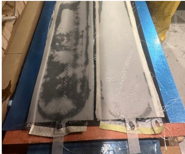
Figura 44: Última capa del laminado. Topsheet.
