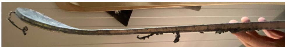
Figura 49: Rebaba resultante del corte con sierra.
