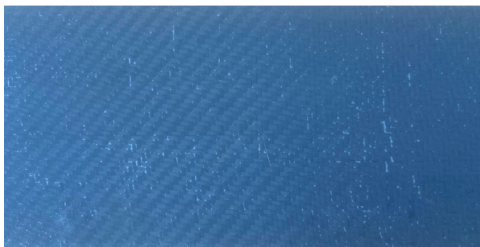
Figura 51: Exceso de resina epoxy.
