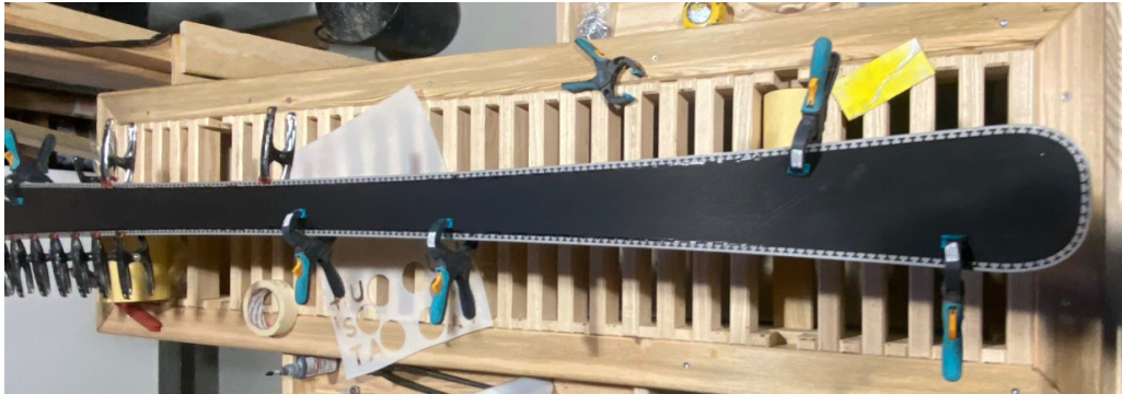
Figura 37: Colocación de cantos en la suela.
