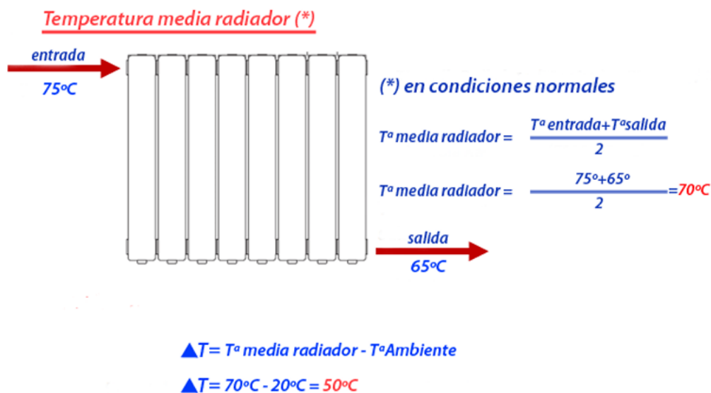
Figura 18. Temperaturas en un radiador convencional [9]
