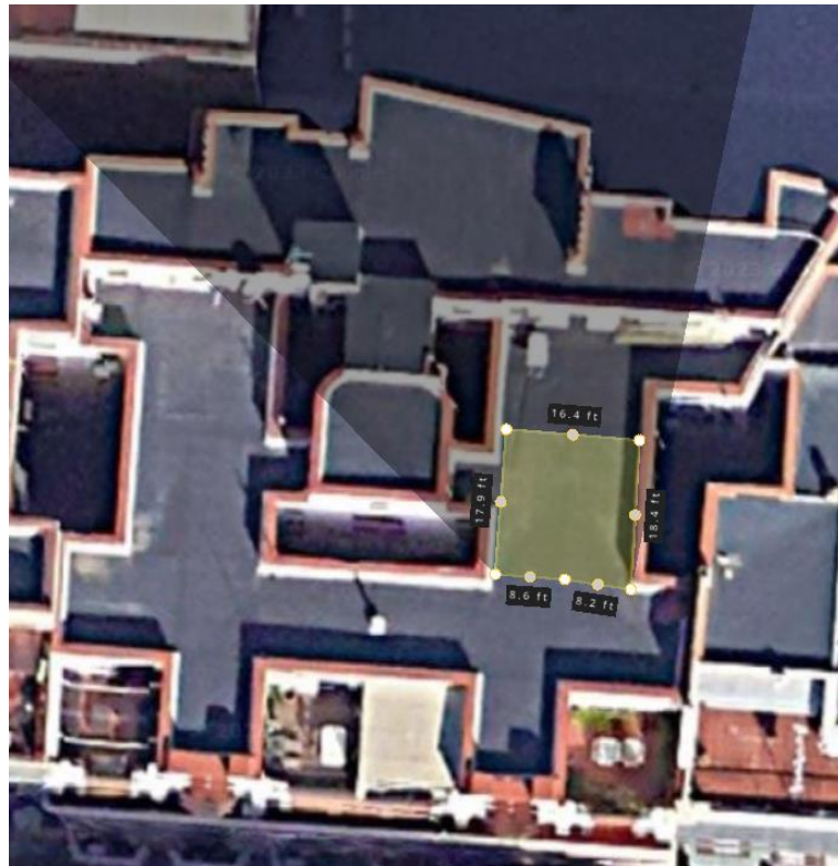
Figura 52. Superficie utilizada para la instalación fotovoltaica
