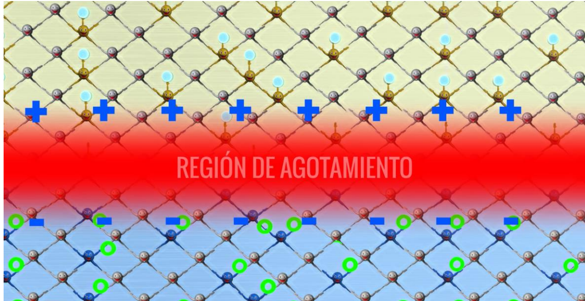
Figura 25. Región de agotamiento en un semiconductor
