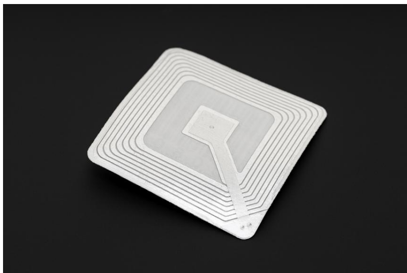
figura 4: Ejemplo de un dispositivo RFID
