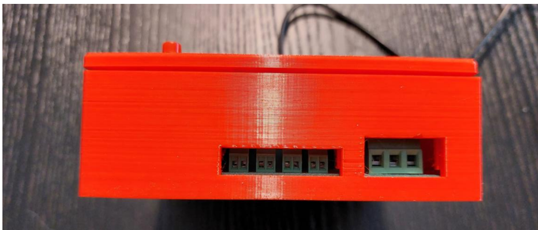
figura 76: Encapsulado, detalle bornas
