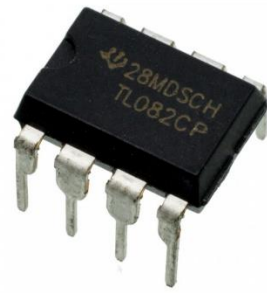
figura 67: Amplificador operacional TL082 y configuración
