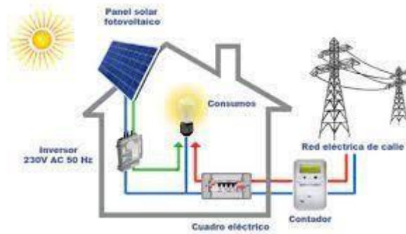
Figura 7 Instalación acoplada a la red
