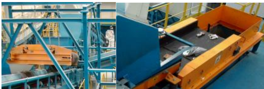
Figura 10 Electroimán y separador de Foucault (Martín Gómez, 2013)
