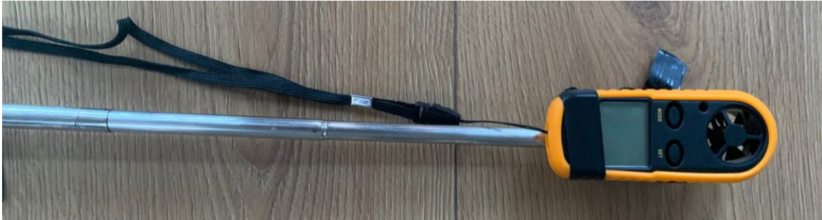
Figura 7-1. Disposición del anemómetro para minimizar perturbaciones en el flujo del viento durante las mediciones.
