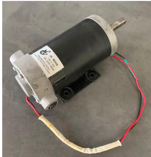
Figura 5-62. Generador escogido para la construcción del modelo.
