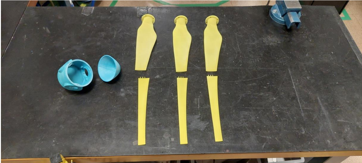
Figura 6-6-2. Resultado de la fabricación de las palas y el buje 108 .
