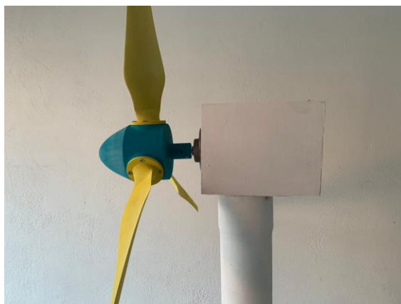
Figura 6-6-6. Góndola con cubierta exterior.
