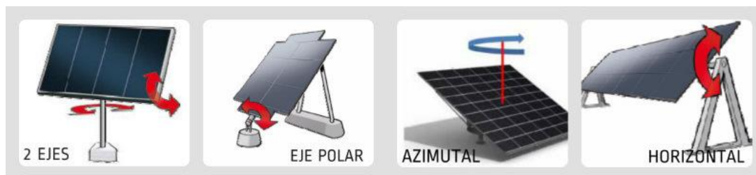
Figura 9: Estructuras móviles genéricas de soporte de paneles solares [46].
