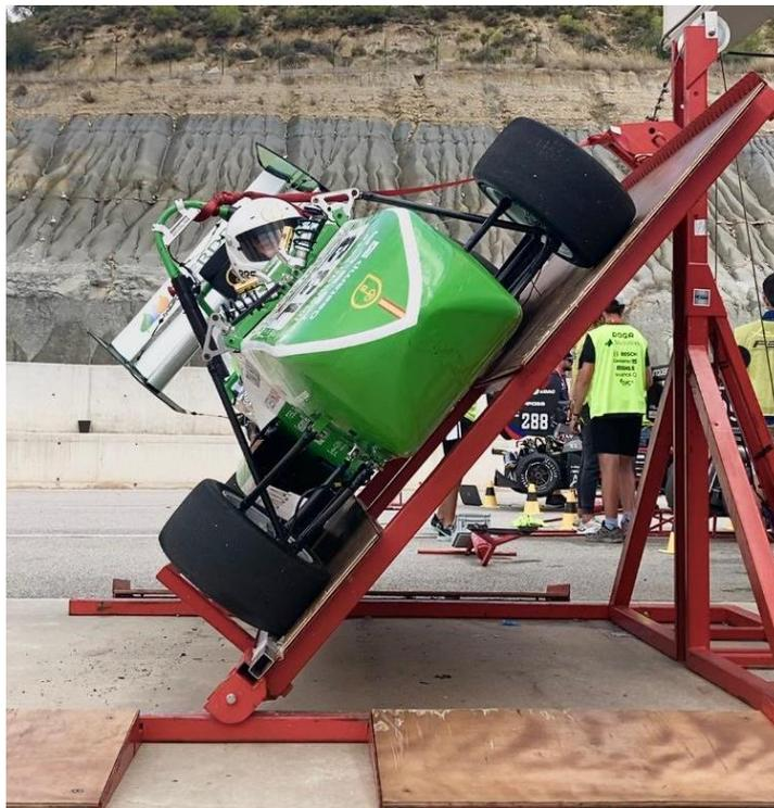
*Ilustración 3: Tilt Test*
