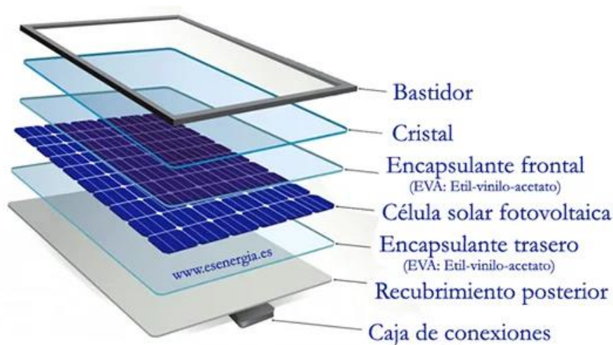
Figura 6: Capas de una placa solar [8]
