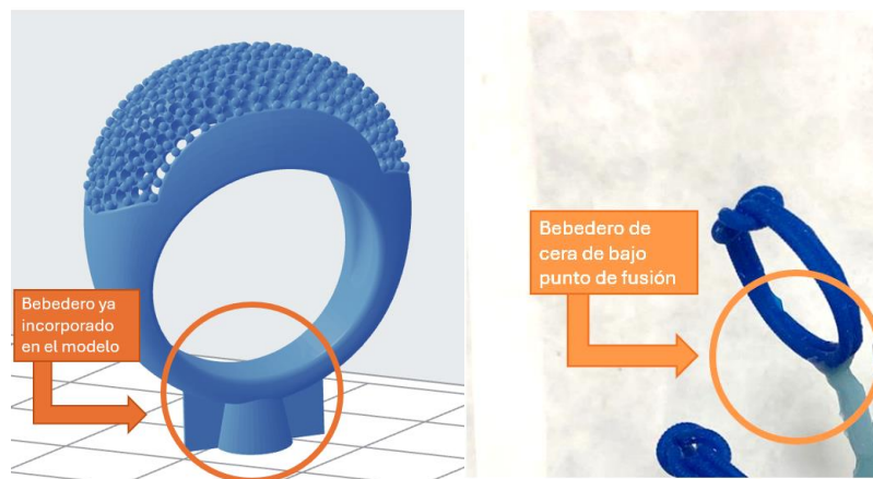
Imagen 37: Tipos de bebederos. Incorporado en el modelo 3D y con cera de bajo punto de fusión. (Elaboración propia)
