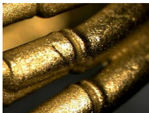
Imagen 130: Cortes por fallos en impresión 3D en el modelo 1
