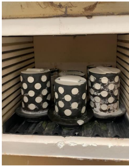
Imagen 54: Cilindros dentro del horno mufla para ser cocidos (Elaboración propia)
