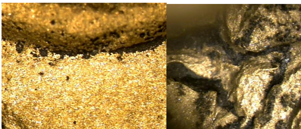
Imagen 74: Pequeñas porosidades y deposiciones de metal mal fundido en piezas finales (Elaboración propia)
