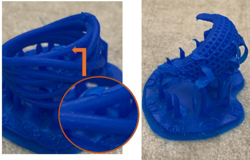
Imagen 83: Pelado observado en la segunda impresión (Elaboración propia)
