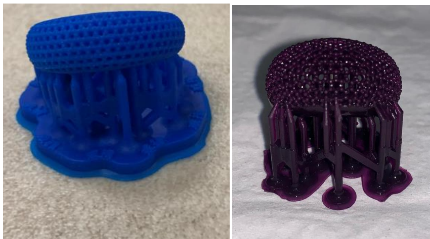
Imagen 105: Comparación del alcance de la Castable Wax 40 y Castable Wax (Elaboración propia)
