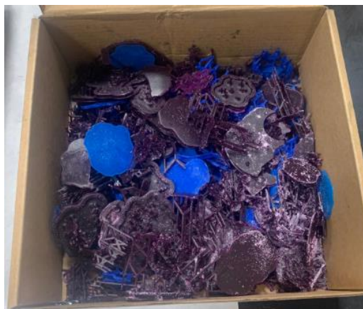
Imagen 201: Residuos de resina calcinable (Elaboración propia)
