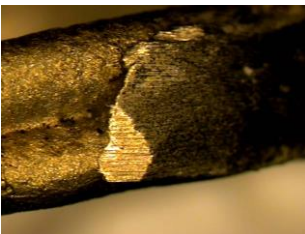
Imagen 140: Detalle de lijado en el modelo 2
