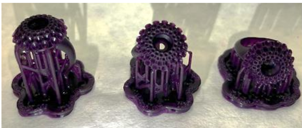
Imagen 103: Modelo 6 de la séptima impresión en detalle (Elaboración propia)
