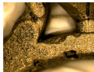
Imagen 168: Llenado incompleto y rechupes del modelo 13
