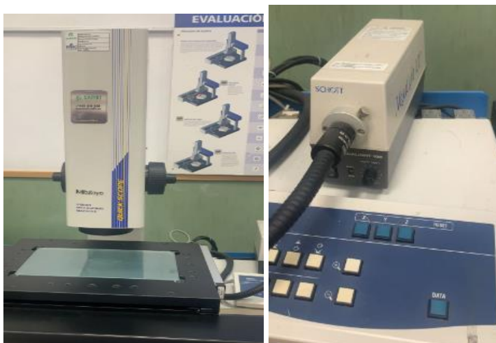
Imagen 123: Máquina de medición manual por visión y lámpara (Elaboración propia)
