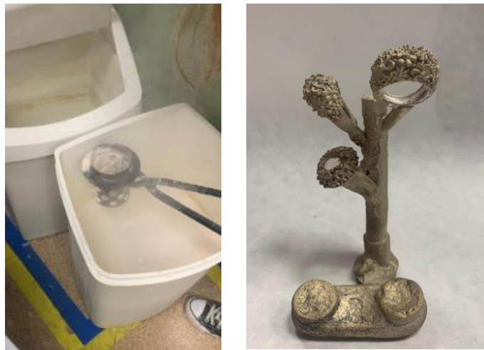
Imagen 67: Obtención del árbol de latón. (Elaboración propia)
