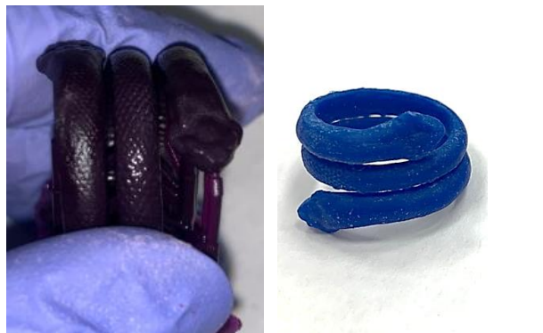
Imagen 104: Comparación del alcance de la Castable Wax 40 y Castable Wax (Elaboración propia)
