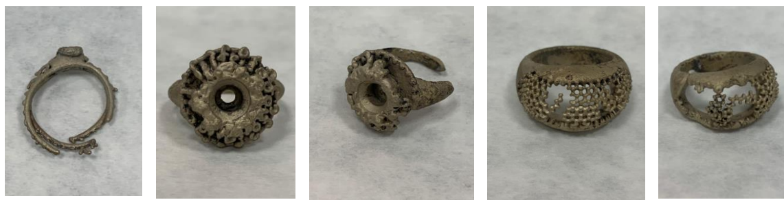
Imagen 115: Piezas obtenidas en la tercera serie del árbol 3. En orden de izquierda a derecha: modelo de muestra de FormLabs , modelo 6, modelo 6, modelo 4 y modelo 4 (Elaboración propia)
