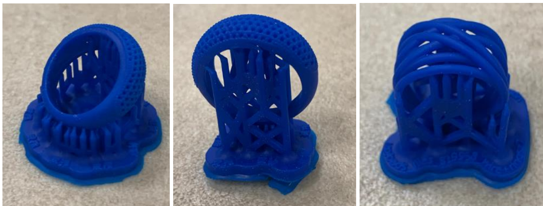
Imagen 79: Piezas con una correcta impresión de la primera tirada (Elaboración propia)
