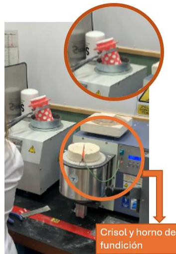
Imagen 62: Cilindro volteado listo para incorporarlo en la aspiración. (Elaboración propia)
