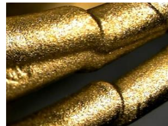
Imagen 129: Cortes por fallos en I3D en el modelo 1
