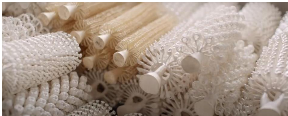
Imagen 200: Fabricación en serie por cera perdida en colado centrifugado de Pandora (Ben Bridge Jeweler, 2014)
