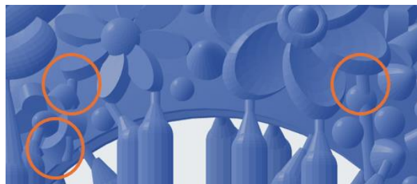
Imagen 88: Soportes internos en una pieza de la tercera impresión (Elaboración propia)
