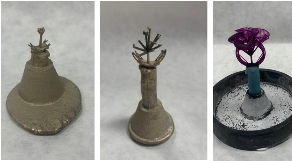
Imagen 120: Serie extra de colado. Dos árboles de fundición. (Elaboración propia)
