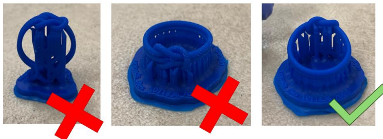
Imagen 77: Correcto posicionamiento de los soportes en la primera impresión (Elaboración propia)
