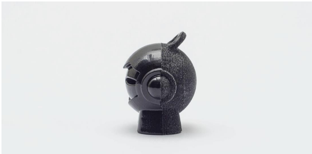
Imagen 14: Figura fabricada con PolyJet. Se aprecia el cambio de superficie brillante a mate. (What is Material Jetting 3D printing?, Protolabs Network, s. f.)
