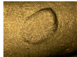
Imagen 142: Marcas de soportes de I3D en modelo 4
