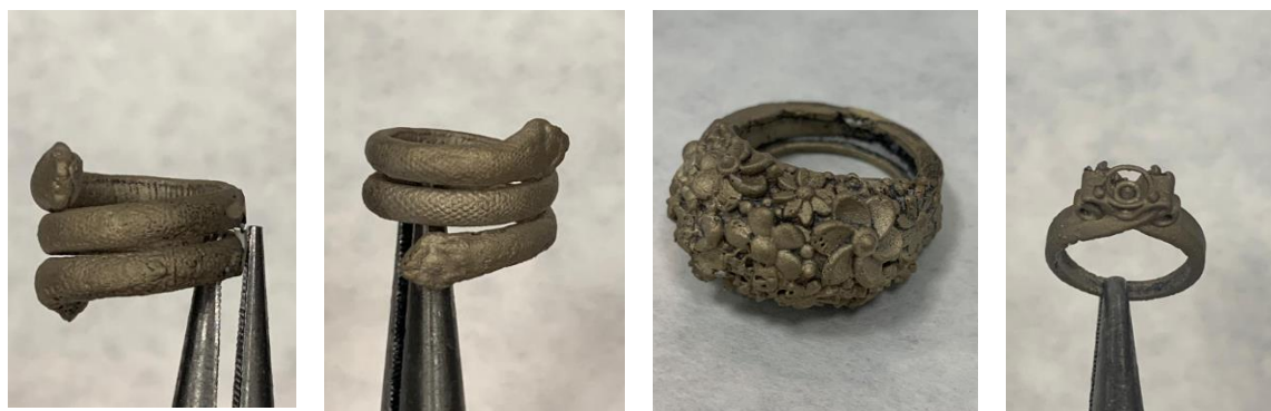
Imagen 116: Piezas obtenidas en la tercera serie del árbol 4. En orden de izquierda a derecha: modelo 2, modelo 2, modelo 12 y modelo descartado en la 6ª impresión. (Elaboración propia)
