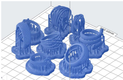
Imagen 27: Ejemplo de cómo colocar las piezas en Preform. (Elaboración propia)
