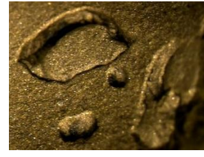
Imagen 146: Sopladuras en el modelo 10
