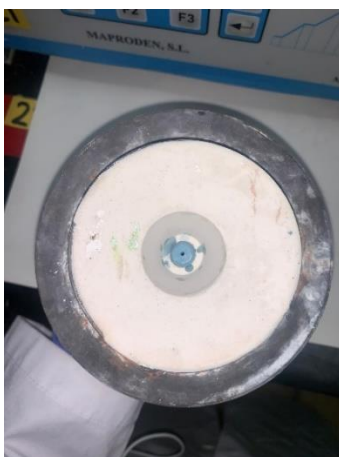
Imagen 53: Imagen del bebedero del molde fraguado (Elaboración propia)
