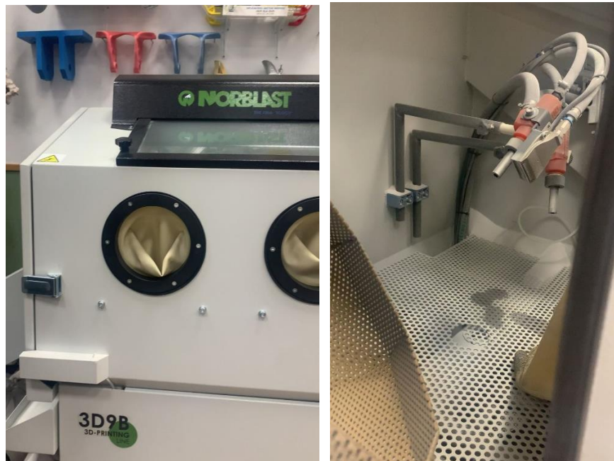
Imagen 190: Imágenes de la chorreadora de arena NORBLAST (Elaboración propia)
