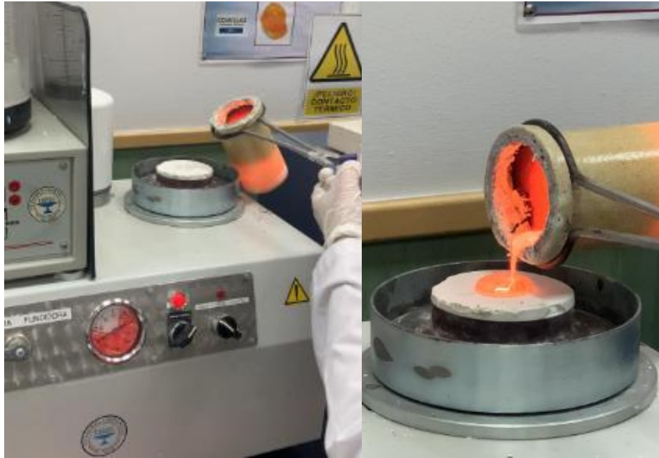
Imagen 64: Colado del latón (Elaboración propia)
