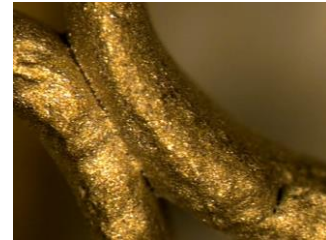
Imagen 181: Fusión inacabada de dos cuerpos del modelo 14
