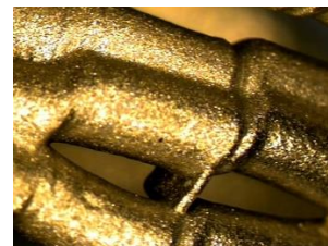
Imagen 132: Cortes por fallos en I3D y soportes internos en el modelo 1
