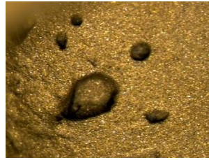
Imagen 145: Sopladuras en el modelo 10
