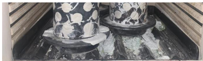
Imagen 56: Detalle de cenizas de resina y demás restos en la base del horno de mufla (Elaboración propia)
