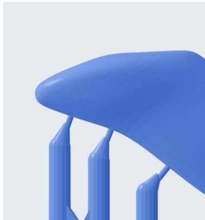
Imagen 87: Punto de contacto en una pieza de la tercera impresión (Elaboración propia)
