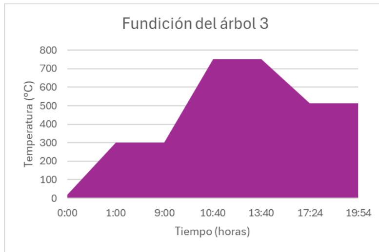
Gráfica 4: Rampa de fundición empleada en el árbol 3 (Elaboración propia)
