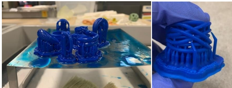
Imagen 30: Piezas de Castable Wax 40 sacadas inmediatamente tras la impresión y pieza en Castable Wax 40 lavada tras impresión. (Elaboración propia)
