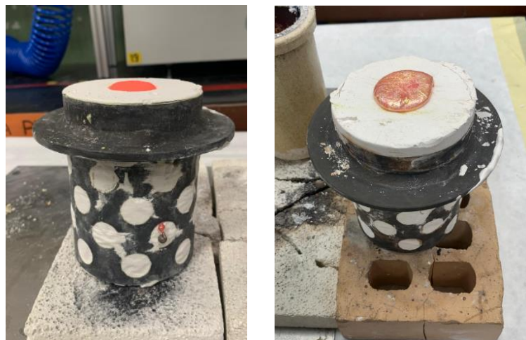
Imagen 65: Enfriamiento del árbol de metal. (Elaboración propia)
