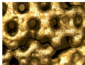
Imagen 149: Grietas en modelo 4
