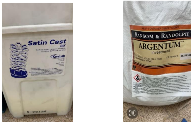
Imagen 43: Revestimientos cerámicos de microfusión. Satin Cast 20 y Argentum Investment (Elaboración propia)
