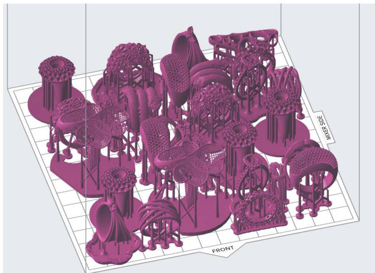
Figura 2: Modelo de anillos en impresión 3D en PreForm (Elaboración propia)
