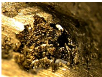
Imagen 185: Rechupe y lijado sobre el modelo 11
