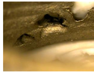
Imagen 141: Rechupe y sopladura en el modelo 1
