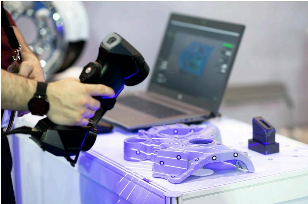
*Figura 13 Escaneo de piezas con escáner 3D, [9]*
