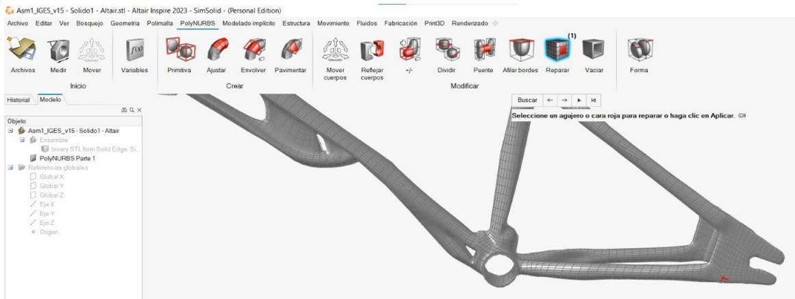
*Figura 103 Reparación de la superficie PolyNurbs, fuente propia*
