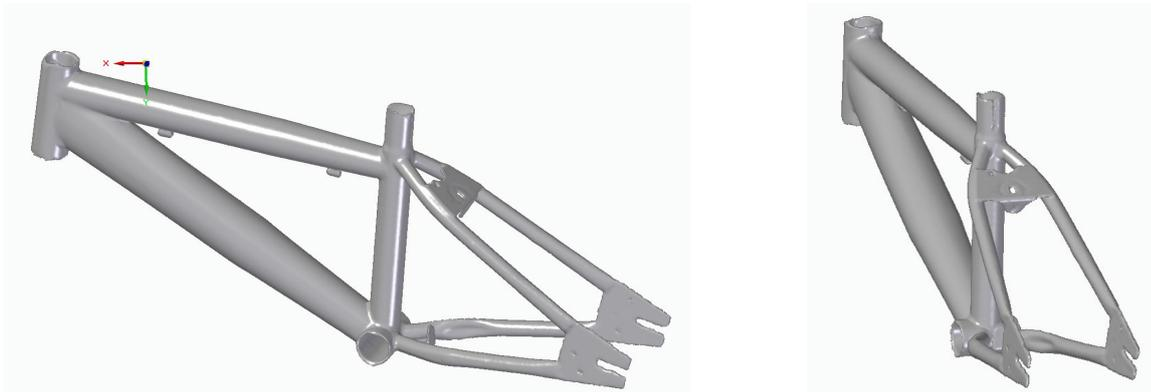
*Figura 63 Modelo CAD del escaneo de una única superficie*
