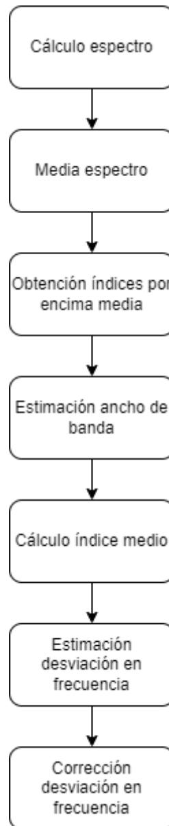
Ilustración 18 Diagrama flujo corrección desvío frecuencia
