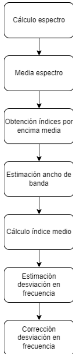
Ilustración 45 Diagrama flujo corrección en frecuencia Autel
