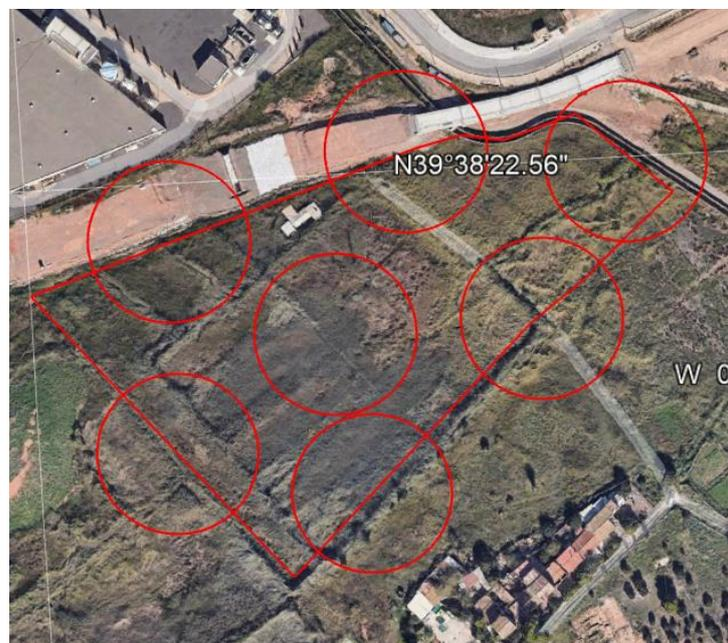
*Ilustración 16: Radio de protección de los pararrayos*
