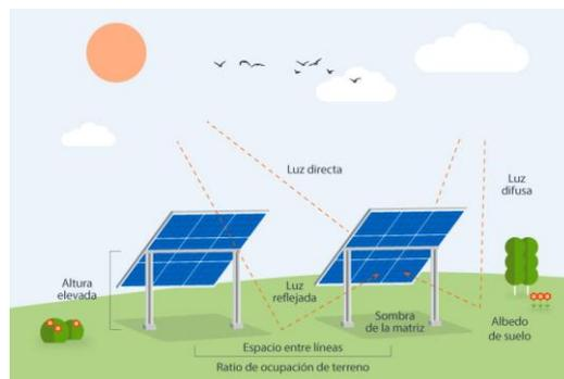
*Ilustración 6: Comparación de paneles estándares con los bifaciales [16]*
