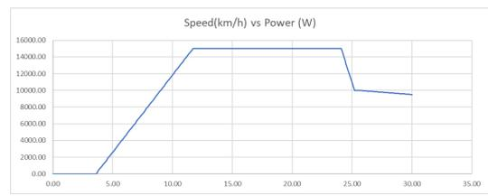
Figura 2: Potencia según la velocidad del viento. Fuente: Elaboración propia
