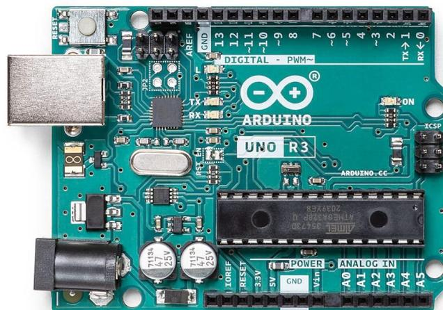
*Figura 31. Placa Arduino Uno R3*
