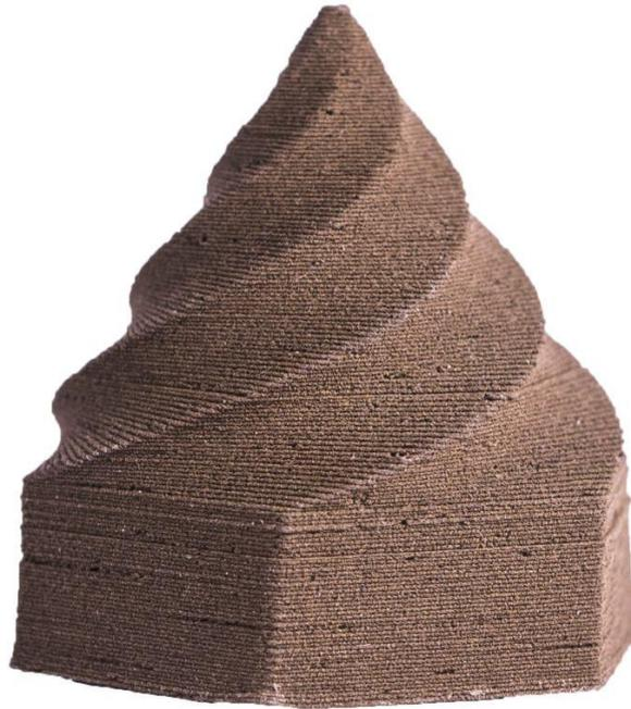
*Figura 45. Pieza impreso con tecnología FDM*
