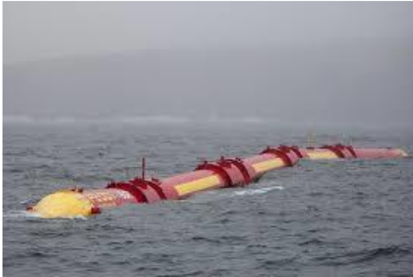
Ilustración 21. Dispositivo cuerpo flotante: Pelamis [17]
