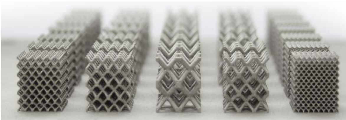
Ilustración 9: Ejemplos de estructura lattice
