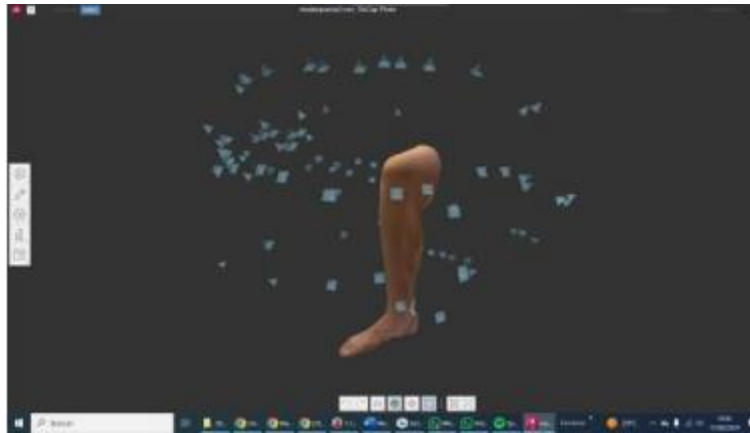
Ilustración 15: Posicionamiento cámara fotogrametría (Fuente Carlos Mas)
