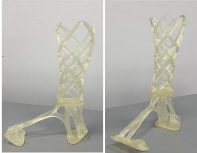
Ilustración 38: Imagen final de la prótesis ya unida
