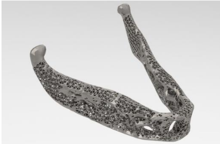
Ilustración 10: Prótesis de mandíbula optimizada topológicamente y estructura lattice [18]
