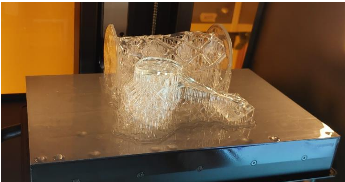
Ilustración 36: Pieza en proceso de impresión
