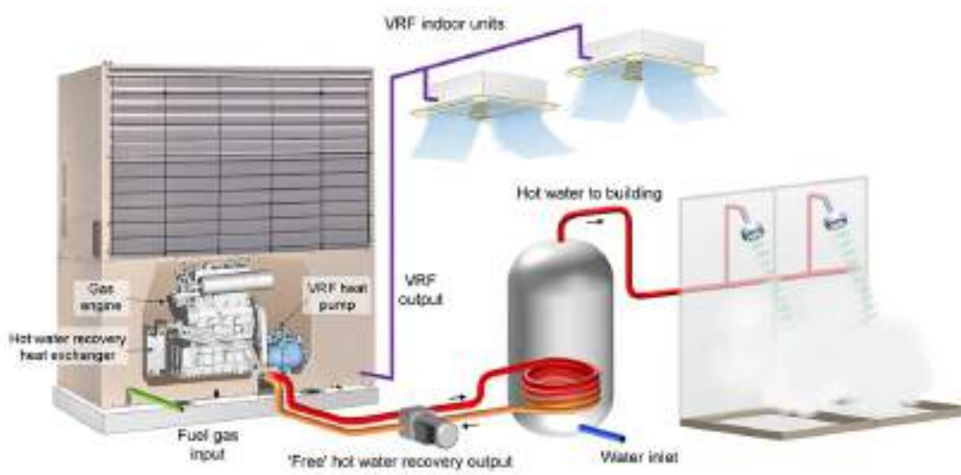
Figura 2.3: Equipo de aerotermia para ACS y climatización. Fuente: Yanmar, 2023
