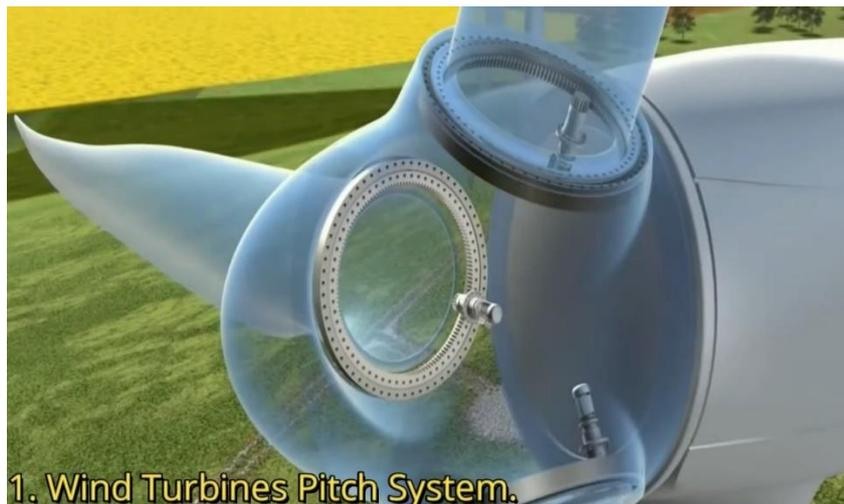
Figura 6. Ilustración del sistema de paso de un aerogenerador, en la disposición con un accionamiento independiente para cada pala. (Tech2, 2020).
