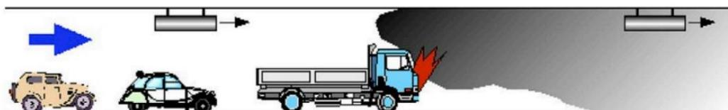
Figura 4. Ventilación longitudinal en caso de incendio [7]
