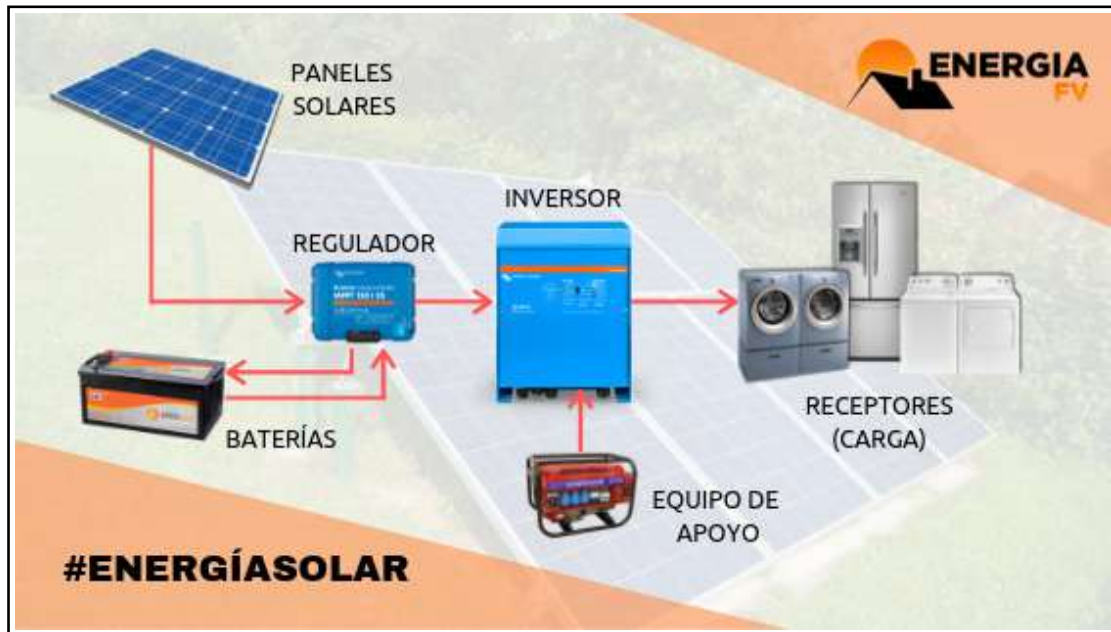
Figura 21: Elementos de una instalación solar aislada. Fuente: [22]
