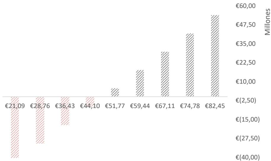
Figura 40 - Sensibilidad del VAN frente al precio de la electricidad (€/MWh) (Elaboración propia)
