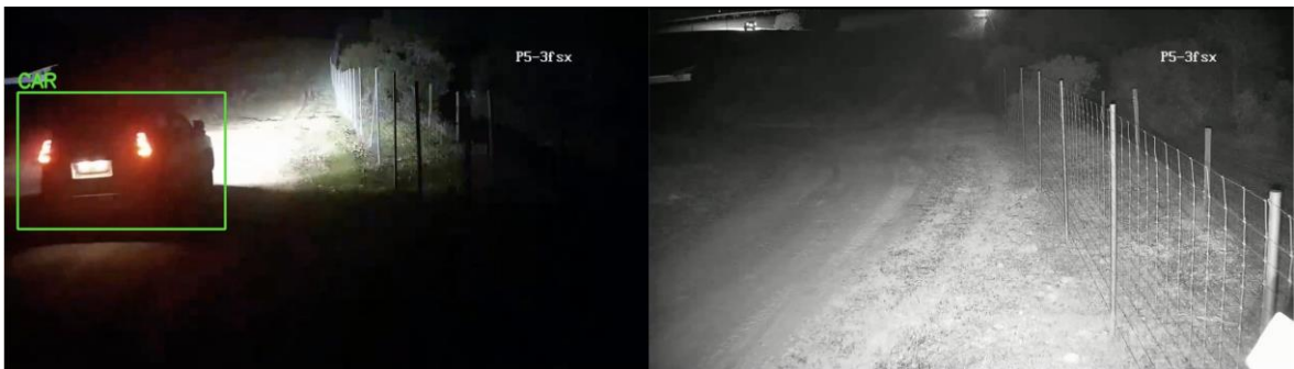
Ilustración 42. A la izquierda, objeto detectado correctamente. A la derecha, objeto no detectado al encontrarse demasiado lejos
