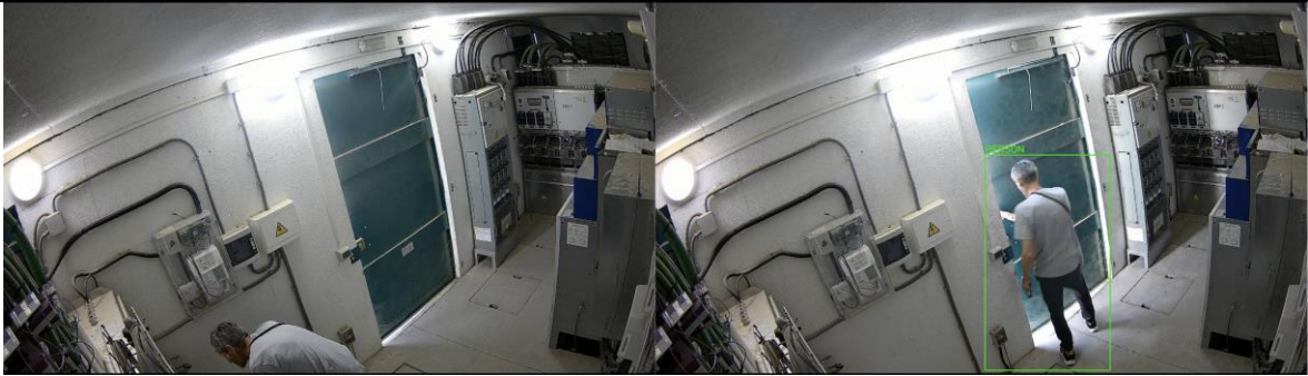
Ilustración 41. A la izquierda, objeto no detectado al no aparecer en su totalidad en el fotograma. A la derecha, objeto detectado correctamente
