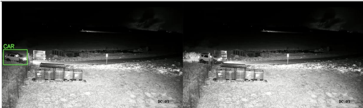
Ilustración 39. A la izquierda, objeto detectado correctamente. A la derecha, objeto no detectado al estar parcialmente tapado por otro objeto
