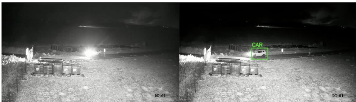
Ilustración 40. A la izquierda, objeto no detectado debido a la fuerte luz que causa un contraluz significativo. A la derecha, objeto detectado correctamente
