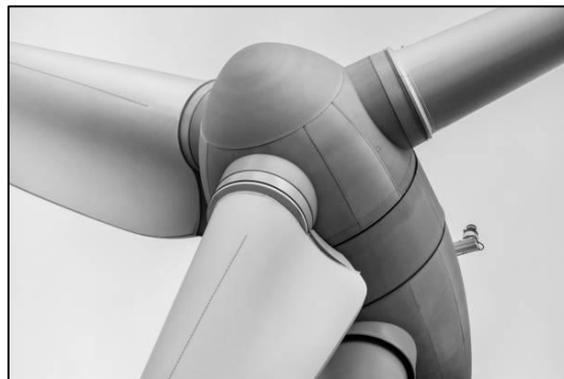
*Ilustración 5: Rotor de un aerogenerador*
