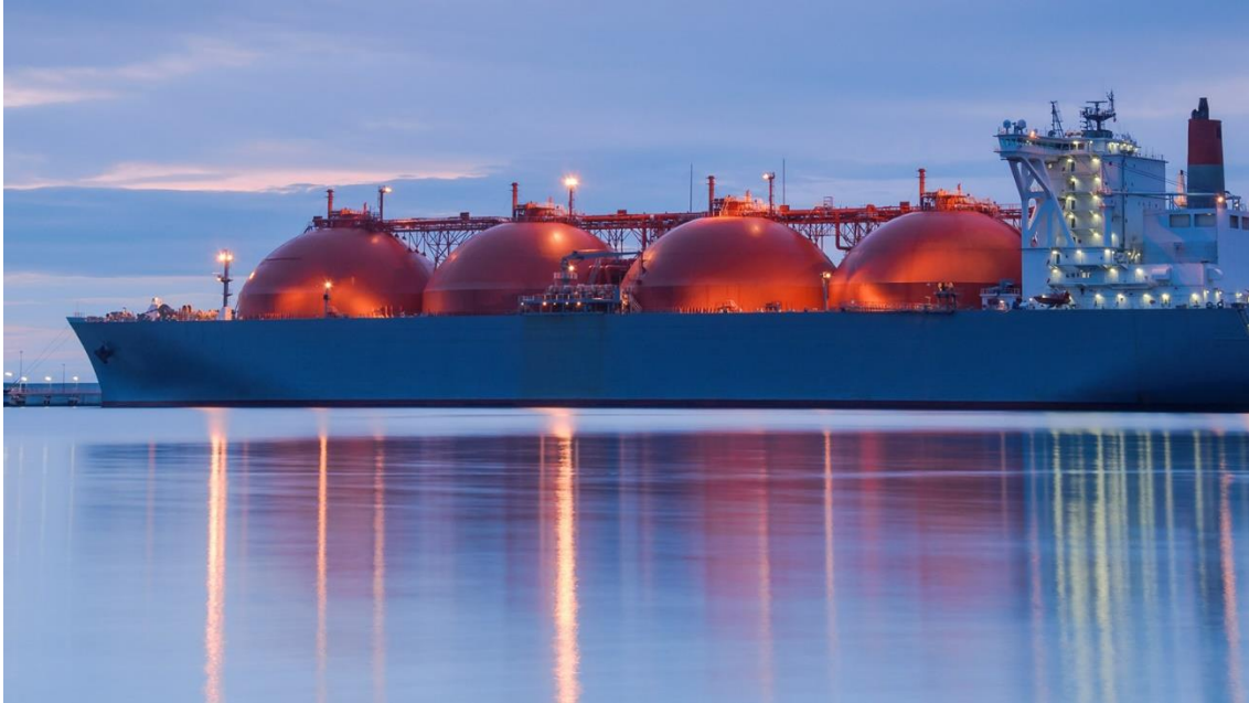
Figura 10. Uso de tanques esféricos en el transporte de hidrógeno líquido [24]
