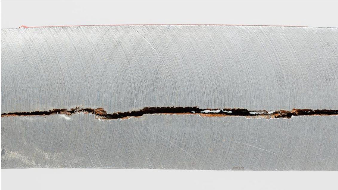
Figura 6. Grieta generada por la fragilización por hidrógeno [18]
